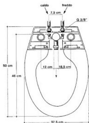
*.Erogatore acqua calda e acqua fredda: Ø 3/8" - Interasse cerniera: 14-19 cm*
